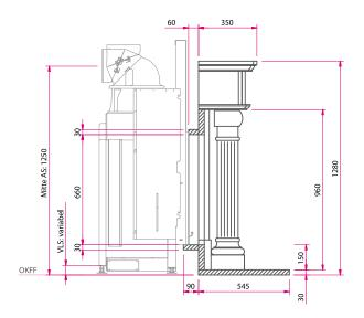
**Hinweis:** Mit **optionalem Zubehör** bitte die Angaben in den Preislisten beachten. **AS:** Abgasstutzen, **VLS:** Verbrennungsluftstutzen, **OKFF:** Oberkante Fertigfußboden
