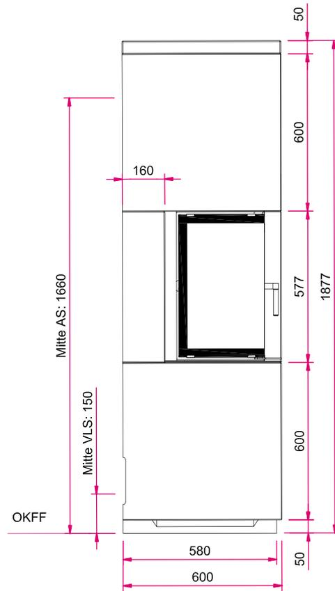
AS: Abgasstutzen, VLS: Verbrennungsluftstutzen, OKFF: Oberkante Fertigfußboden
